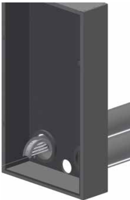
Kunststoffgitter NW170 durch Öffnung führen
