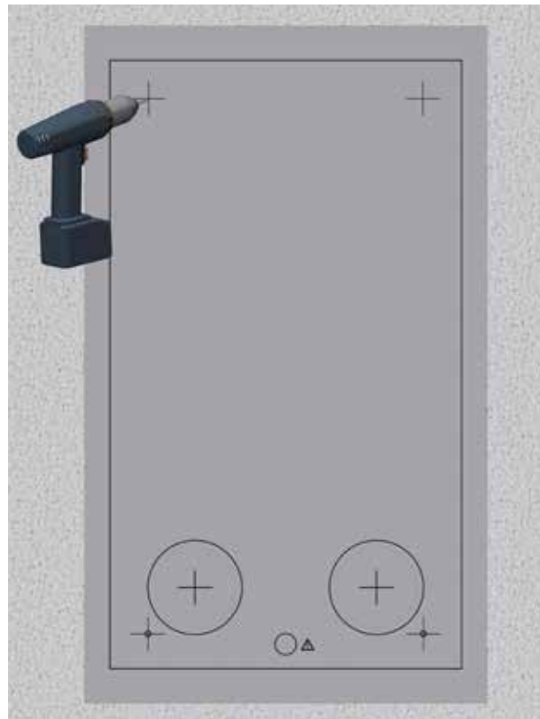
Markierte Löcher bohren
